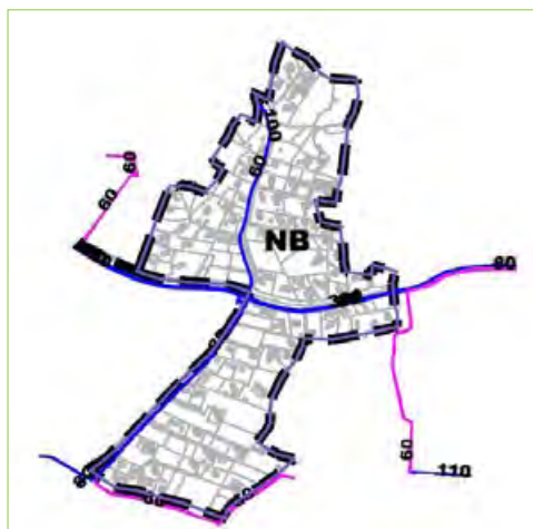
RÉSEAU D'ALIMENTATION EN EAU POTABLE
