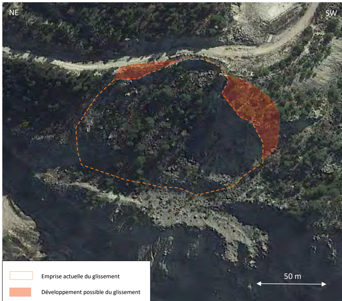
Figure 20 : Zone d'instabilités haute (n°2) (Google Earth, 2018)
