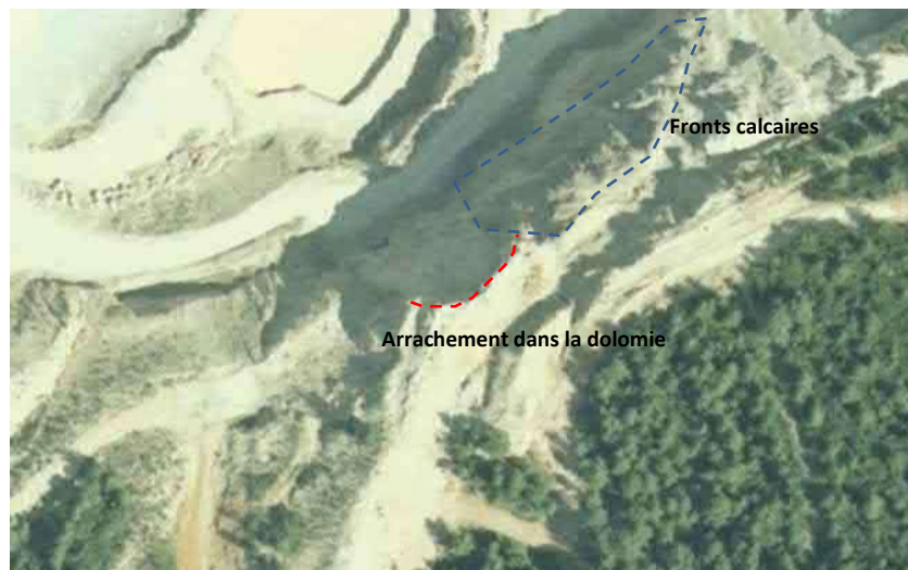
Figure 9 : Premières figures d'arrachement dans la dolomie verticalisées au contact avec les calcaires (IGN, 1989)
