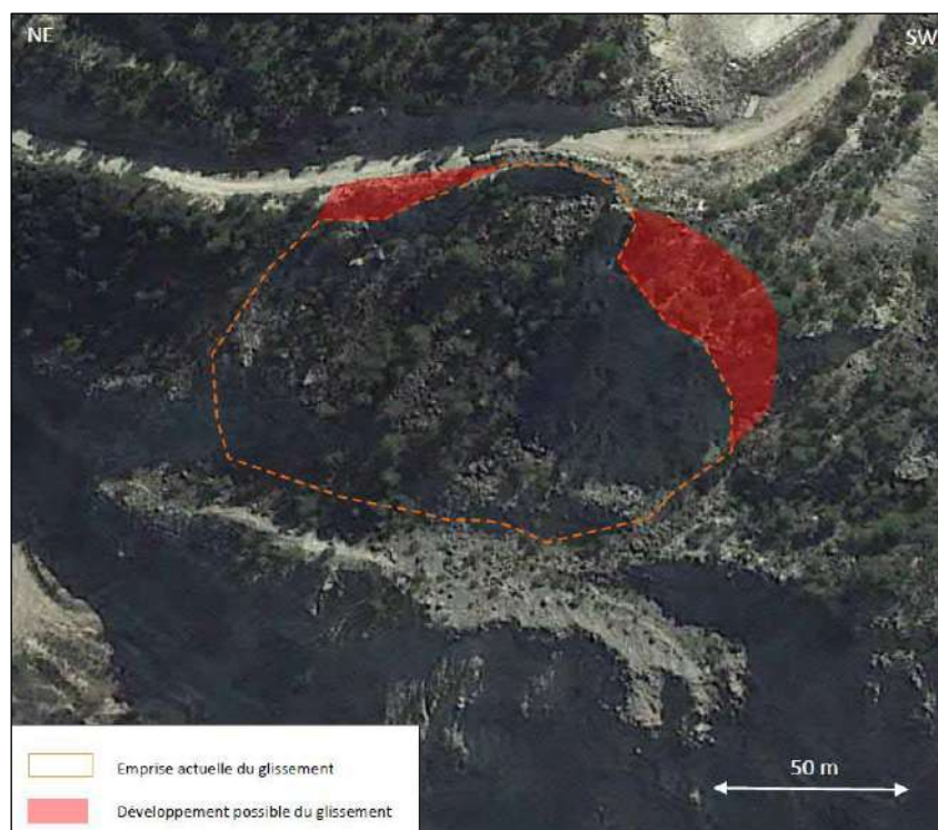
Figure 63. Zone d'instabilité haute (MICA Environnement)
